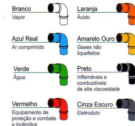
Figura 37 - Cores das Tubulações (Representação genérica), de acordo com a NBR 6493 (1994).
